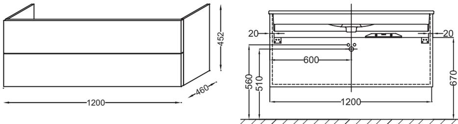
Спецификация продукта : Мебель для раковины-столешницы, изогнутая ручка 120 x 46 x 45,20 см. EB2071-R1. Коллекция : VOX. РАЗМЕРЫ (CM) : 120 x 46 x 45.20 см. ВЕС : 29 кг. МАТЕРИАЛ : Лак или меламин. НОРМЫ И ПРАВИЛА : NF. RANGEMENT : 2 выдвижных ящика с механизмом «плавное закрывание». TYPE DE RANGEMENT : Выдвижные ящики. POIGNÉE : Изогнутая ручка. FIXATION : Установщику понадобится набор крепежей для монтажа на стену.
